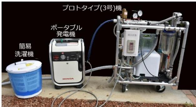
写真-2 プロトタイプ機と周辺装置の組み合わせ例
