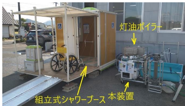
写真-3 組立図シャワーブースとの連携
