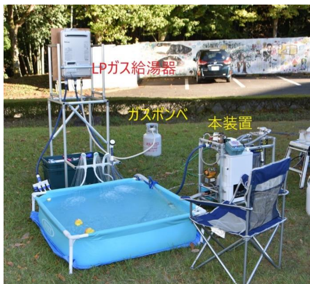
写真-4 LP ガス給湯機を用いた足浴提供のセット
