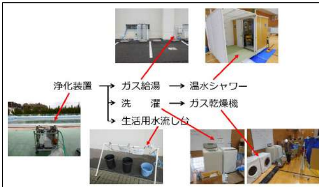
図-11 小丸山小学校での生活水の多目的供給
